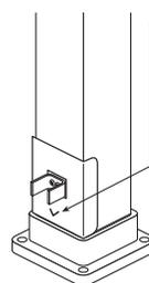
Coloque la guía sobre la placa de la base, con la flecha hacia abajo.
